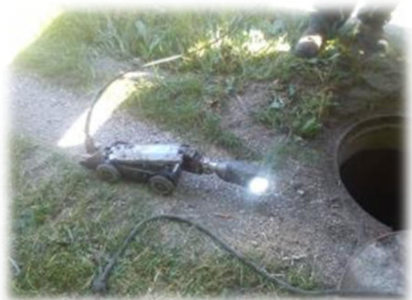
Photos de la caméra inspectrice sur charriot motorisé
